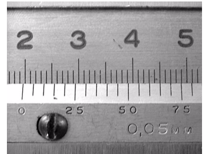
1. att. Mērījumu rezultātu nolasīšana no bīdmēra skalas.
